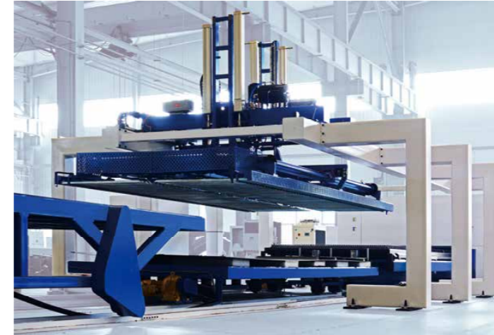
自动上下料装置（上料吸盘机构/下料指状托料架） Sucking device for loading / finger support for unloading
