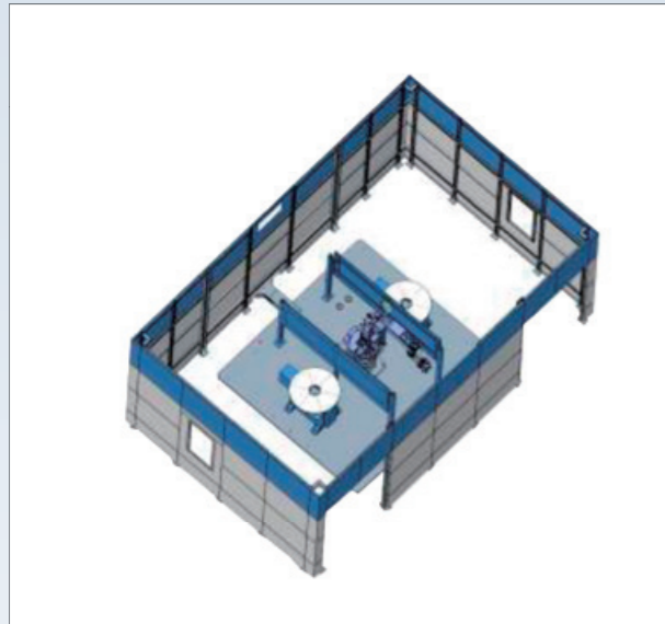
配置双工位 P 型双轴变位机
